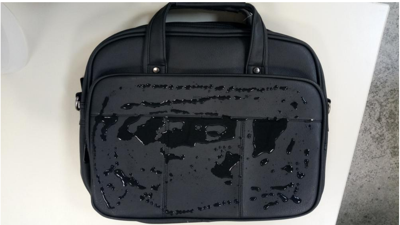
Imagem 12: Teste de impermeabilidade da maleta
